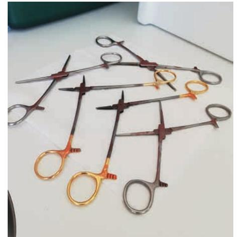
Die Prüfkörper, z. B. Crile-Klemmen, werden dem Reinigungsprozess unterzogen und anschließend im Labor auf Restproteine überprüft
