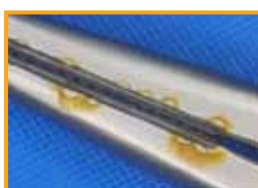
Korrodierte Lotnaht bei einem Hartmetallnadelhalter und einer Hartmetallschere. Ursache: Phosphorsäureangriff durch Überdosierung der Neutralisationschemie.
