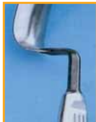
Wundhaken mit schwarz verfärbtem Schaft aus gehärtetem Cr-Stahl und blank gebliebenen Griff und Blatt aus nicht härtbarem CrNi-Stahl
