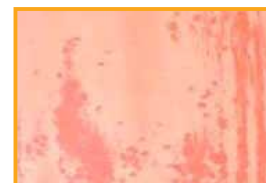
Starker Materialangriff natur- und farbeloxierter Aluminiumoberflächen bei einem Instrumentenständer und Containern. Ursache: Überdosierung der sonst materialverträglichen alkalischen Waschlösung.
