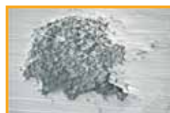
Korrosionsloch – betrachtet unter Rasterelektronenmikroskop – 200-fache Vergrößerung
