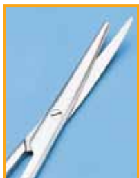
Schere mit abgebrochener Spitze. Ursache: unsachgemäßes Ablegen
