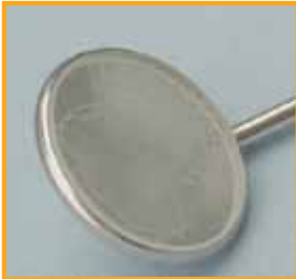
Verfleckungen auf Grund hohen Salzgehalts im Abspülwasser
