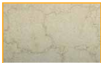
Fleckenmuster durch Verunreinigungen im Dampfcondensat
