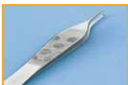
Flecken auf einer Pinzette: Ursache: Unzureichende Dampfqualität
