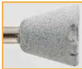
Polierer mit Materialausbrüchen am distalen Ende
