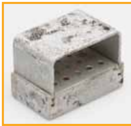
Stark angegriffener eloxierter Aluminiumständer
