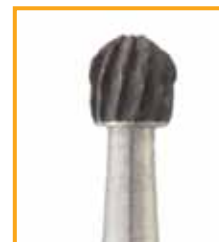
Korrodierter, verschlissener Hartmetallbohrkopf aus WC/CO. Ursache: Anwendung eines sauren Reinigers.
