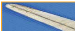
Korrodierte Lotnaht bei einem Hartmetallnadelhalter und einer Hartmetallschere. Ursache: Phosphorsäureangriff durch Überdosierung der Neutralisationschemie.
