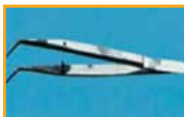
Links: Partieller Materialangriff durch sauren Zemententferner und rechts durch Tinktur zur Blutstillung. Ursache: zu lange Kontaktzeit oder unzureichende Entfernung nach Anwendung.
