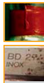
Lochkorrosionsbefall einer Pinzette. Ursache: Überalterung des Farbcodierungsbandes lässt Unterwanderung schädlicher, chloridhaltiger Substanzen zu.
