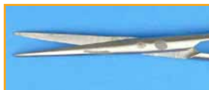
Links: Partieller Materialangriff durch sauren Zemententferner und rechts durch Tinktur zur Blutstillung. Ursache: zu lange Kontaktzeit oder unzureichende Entfernung nach Anwendung.
