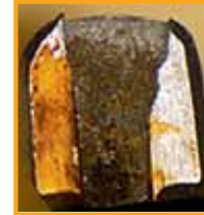
Detail: Maulbruch-Klemme mit typischer körniger, interkristalliner Bruchstruktur.
