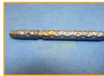
Verfärbter Instrumentengriff aus Titanwerkstoff
