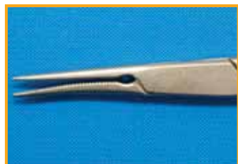
Verformung durch unsachgemäße Handhabung
