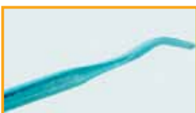
Korrodiertes Füllspatel Ursache: Anätzung durch sauren Zemententferner
