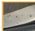
Schere mit Lochkorrosion
