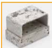
Starker Materialangriff natur- und farbeloxierter Aluminiumoberflächen bei einem Instrumentenständer und Containern. Ursache: Überdosierung der sonst materialverträglichen alkalischen Waschlösung.
