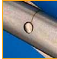
Detail: Schlussgelenk Schere mit typischem interkristallinem Anriss.
