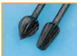
Rost an Bohrem Ursache: Aufbereitung eines Einmalinstrumentes
