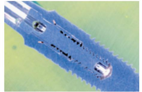
Längsschliff eines Trias®-Implantates: Im Inneren sind keine Harzanteile festzustellen.
