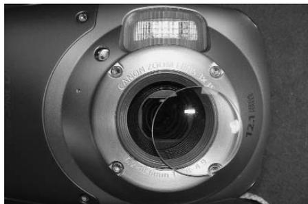
Abb. 3 b – Vorderseite mit Nahlinse
