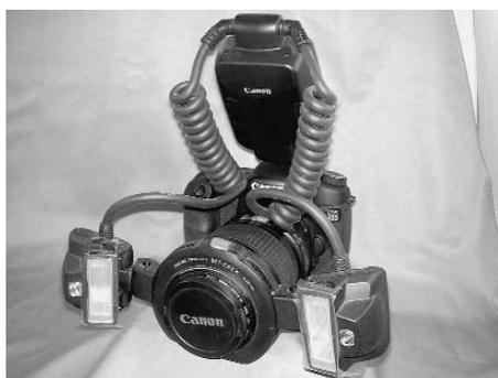
**Abb. 7 – Canon EOS 40D mit EF 100 mm Macro USM und Canon Macro Twin Lite MT-24EX Lateralblitz**
