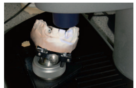
Abb. 9 – Optisches Scannen eines Gipsstumpfes im zahntechnischen Labor
