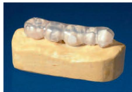
**Abb. 1 – Zweite Versuchsanordnung zur experimentellen Prüfung der Streustrahlung bei verschiedenen Dentalwerkstoffen. Die Zähne A bis E sind von rechts nach links angeordnet. Um die Zähne noch differenzieren zu können, wurde nur für diese Abbildung eine dünnere Tiefziehfolie verwendet.**
