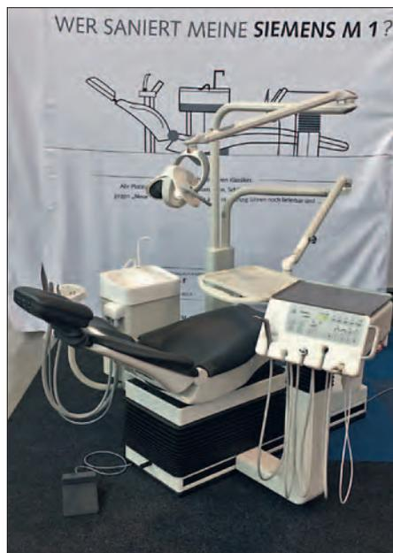
Gewohntes Handling und eingeübte Greifwege bleiben damit erhalten. Neue Platinen, Bronzeventile, Hub- und Rückenlehnenmotoren sowie neue Kabel- und Schlauchwege garantieren ein optimal saniertes Gerät und die Unabhängigkeit von Ersatzteillieferungen.
