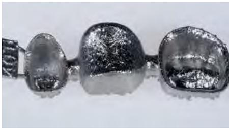
Abb. 6 a – Lasergesintertes Brückengerüst aus CoCr-Legierung
