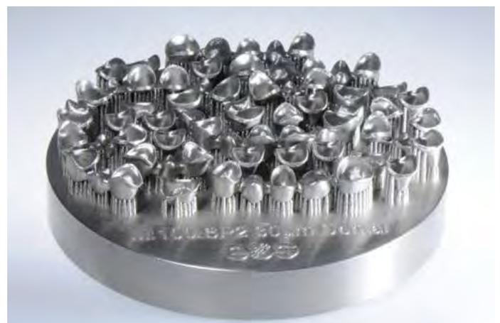
Abb. 2 – Im direkten Lasersinterverfahren hergestellte Gerüste für festsitzenden Zahnersatz aus CoCr
