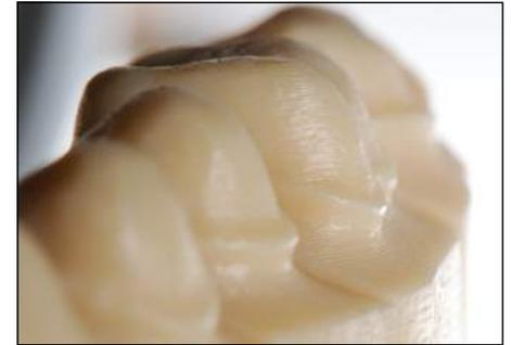
Abb. 15 – Die Oberflächenqualität wird maßgeblich von der Dicke der einzelnen Schichten und der damit verbundenen Stufenbildung (Z-Stufung) beeinflusst
