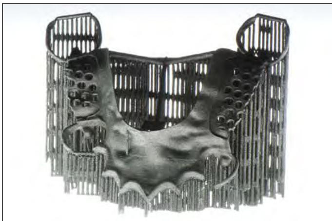
Abb. 7 – Im direkten Lasersinterverfahren hergestelltes Modellgussgerüst
