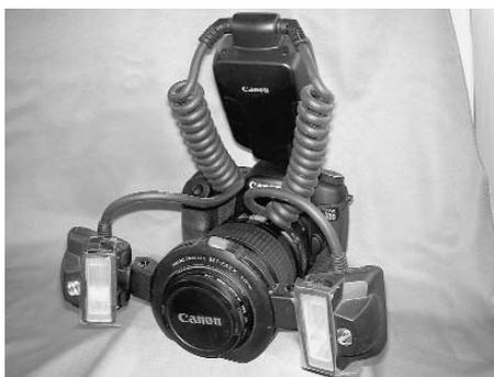
**Abb. 7 – Canon EOS 40D mit EF 100 mm Macro USM und Canon Macro Twin Lite MT-24EX Lateralblitz**
