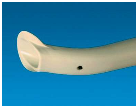
Abb. 1 a – Absaugkanüle mit Perforation zur Prävention eines Rückflusses aus dem Absaugschlauch, Drehhülse (Firma Dürr) mit zusätzlichen Lufteinlässen (rechts)
