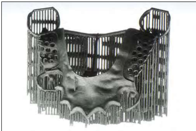
Abb. 7 – Im direkten Lasersinterverfahren hergestelltes Modellgussgerüst
