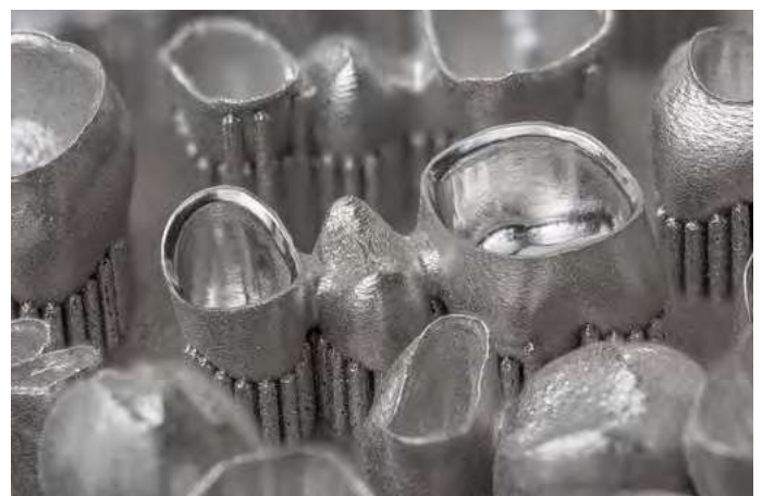
Abb. 9 a und b – Hybridfertigung: Additiv im Lasersinterverfahren hergestellte CoCr-Gerüste werden durch eine CNC-Nachbearbeitung subtraktiv in der Passgenauigkeit verfeinert (Quelle: Datron – hochkant in/am Bild a und b).
