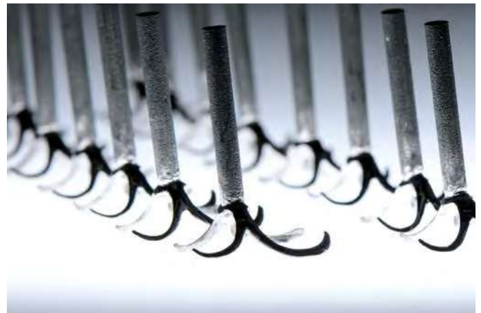
Abb. 8 – Lasergesinterte Modellgussklammern (Studie)
