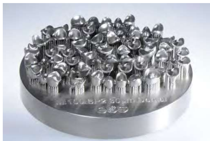
Abb. 2 – Im direkten Lasersinterverfahren hergestellte Gerüste für festsitzenden Zahnersatz aus CoCr
