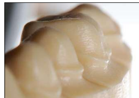
Abb. 15 – Die Oberflächenqualität wird maßgeblich von der Dicke der einzelnen Schichten und der damit verbundenen Stufenbildung (Z-Stufung) beeinflusst
