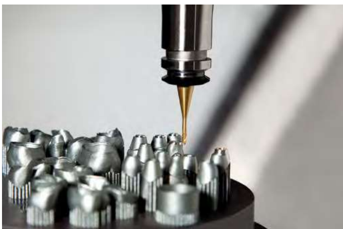
Abb. 9 a und b – Hybridfertigung: Additiv im Lasersinterverfahren hergestellte CoCr-Gerüste werden durch eine CNC-Nachbearbeitung subtraktiv in der Passgenauigkeit verfeinert (Quelle: Datron – hochkant in/am Bild a und b).
